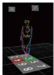
計測したデータから身体重心や関節角度、関節モーメントなどを算出
