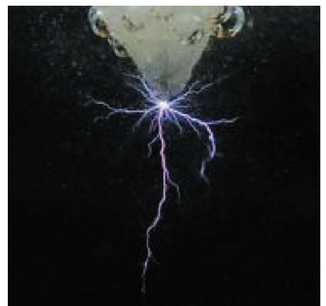
図1 水中放電の様子(ストリーマの発光)
