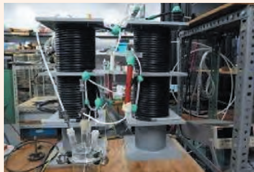
図2 水中・水面上放電用に製作したコンデンサの代わりに同軸ケーブルを使用するブルームライン形パルス電源(発生電圧:40kV、パルス幅100ns)
