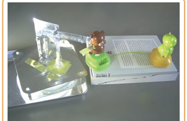
「目印に合わせて組み立てれば動く」がコンセプトの低温度差スターリングエンジンが熱エネルギーを運動エネルギーに変換して「くま」に伝え, 「くま」がそれを電気エネルギーに変換し, 「きょうりゅう」がその電気エネルギーを運動エネルギーに変換する。
