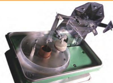
ホームセンターの店頭で購入可能な材料と工具で手作りした低温度差スターリングエンジン, よく似た装置で研究もした
