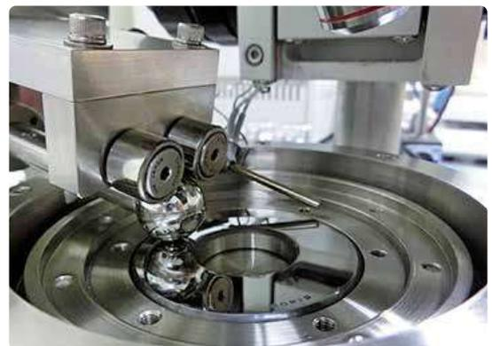
ボールオンディスク型摩擦試験機
