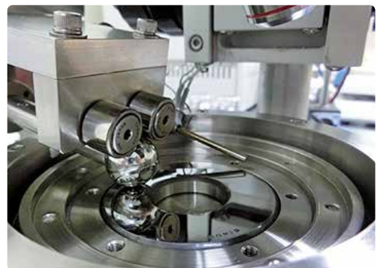
ボールオンディスク型摩擦試験機 実機での摩擦条件に合わせ、新たな試験機を研究室で開発し、実験に使用しています。
